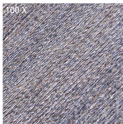
ZECHA Ra 0,113 µm ZECHA Ra 0.113 µm
