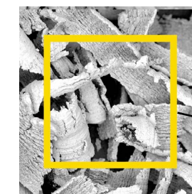
Durch das Fräsen entstandene Späne - Größe ca. 5 bis 8 µm Chips caused by milling - size approx. 5 - 8 µm
