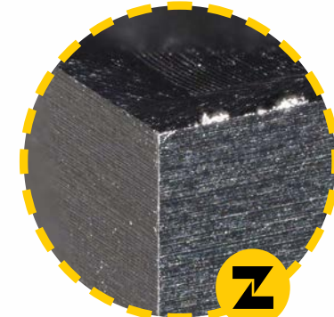
IGUANA-Werkzeuge sorgen für homogene Oberflächen und minimierte Gratbildung
